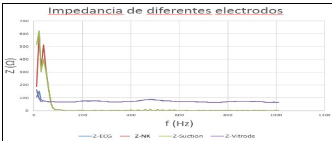
Figura 8. Diferentes tipos de electrodos y resultados obtenidos con el KIT AD5933 para la caracterización de su impedancia.
