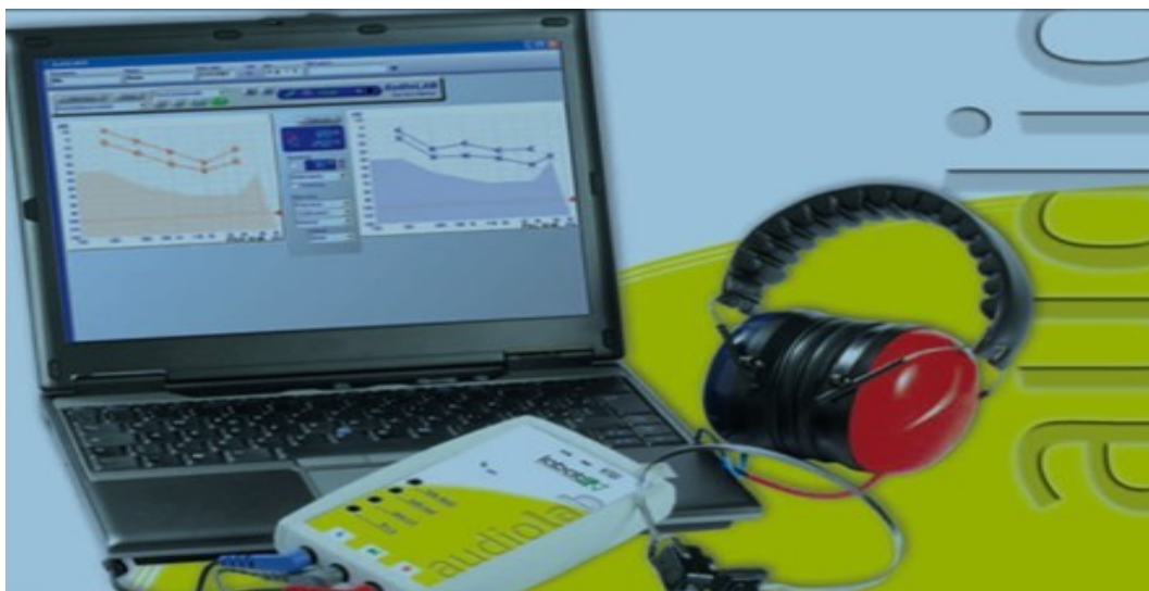
Figura 1. Equipo usado para realizar estudio- Audiolab, audífono de AAF HDA 200
